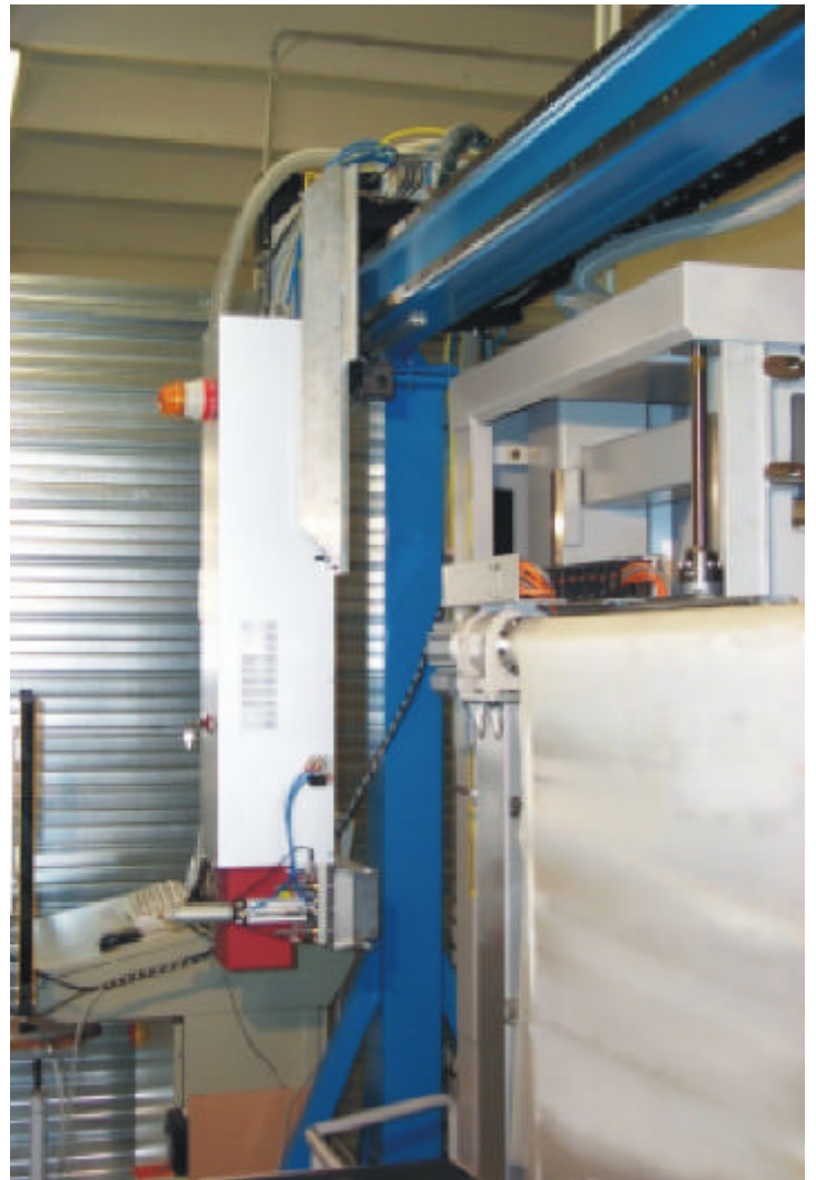
Láser Instalado en una Epoca Saurer
